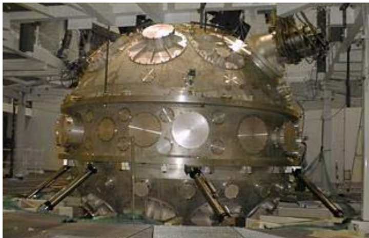
Positionnement d'une sphère de 17 tonnes. Résolution de 0,5 mm.
